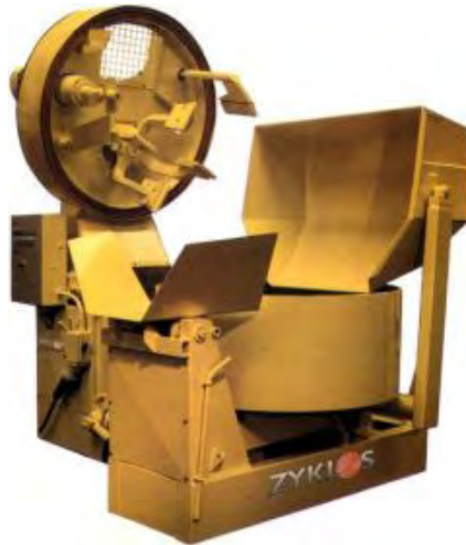
Abbildung 4.11: Ansicht eines geöffneten Mixers der Fa. Zyklus mit 375 l Mischvolumen, Herstellerbild Fa. Zyklus
