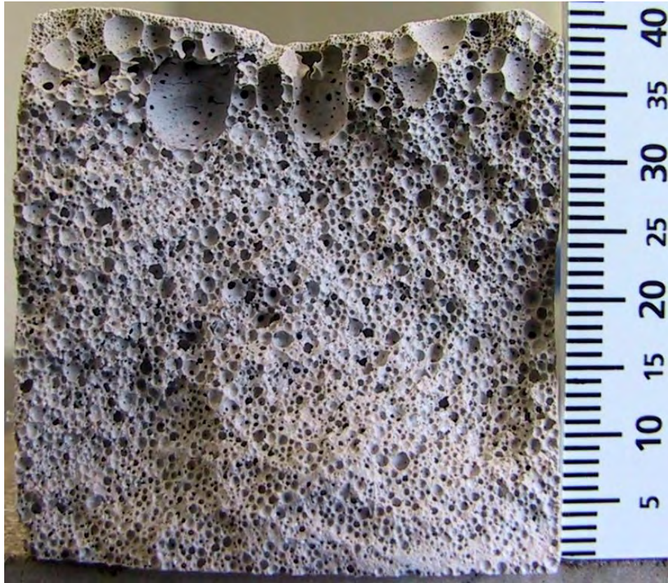
Abbildung 4.30: Bruchfläche eines Zementschaumprismas mit von unten nach oben zunehmendem Volumenbruch und zunehmenden Porengrößen
