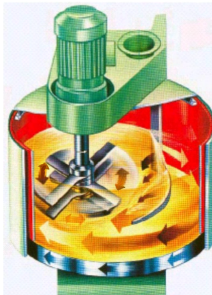
Abbildung 5.1: Intensivmischer, Quelle Fa. Eirich, verändert
