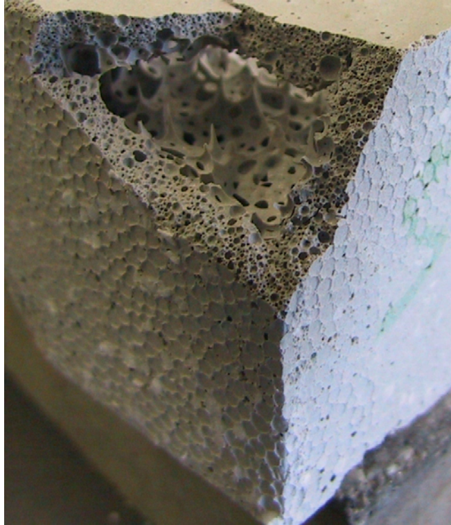
Abbildung 4.28: Schaumprisma mit ausgedehntem Hohlraum durch oberflächliche Schaumstabilisierung und inneren Schaumzerfall
