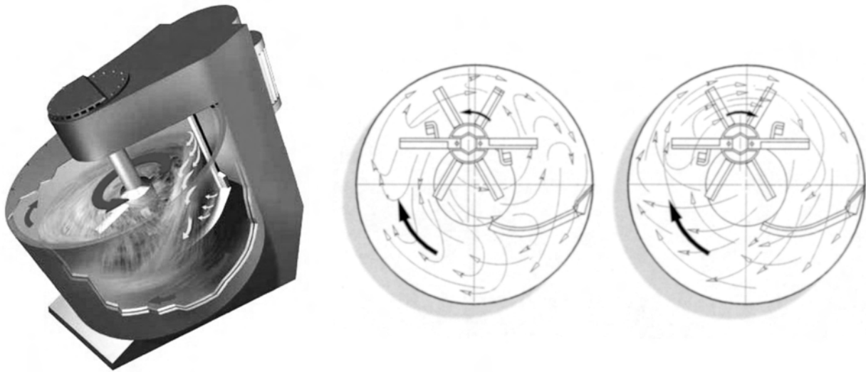
Abbildung 4.12: Darstellung des Mischprinzips der Eirich-Intensivmischer, aus Produktinformationen der Fa. Eirich
