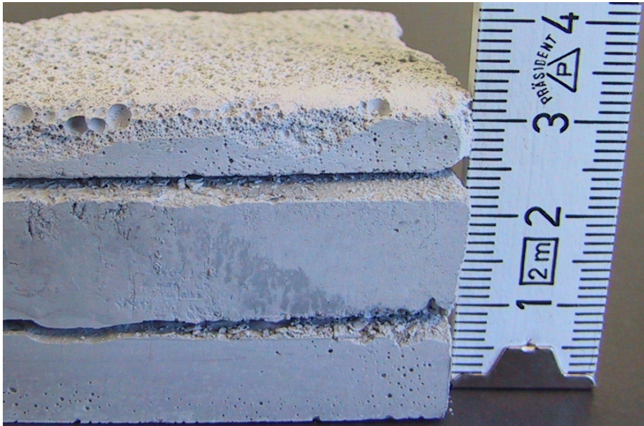
Abbildung 4.22: Prisma mit ausgeprägtem horizontalen Schichtaufbau durch Drainage und Sedimentation
