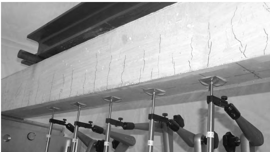
Bild 5-10: Messstellen der Wegaufnehmer
