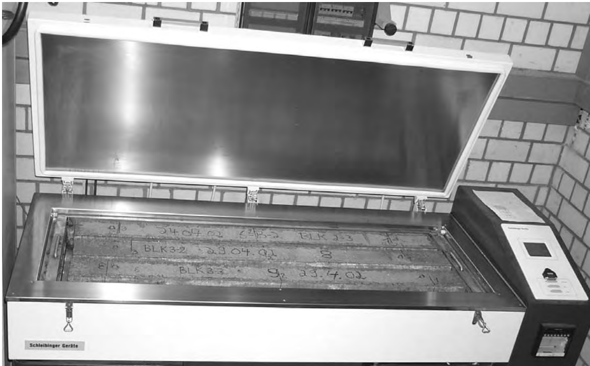
Bild 5-3: Befrostung der Biegebalken in der CIF-Frosttruhe
