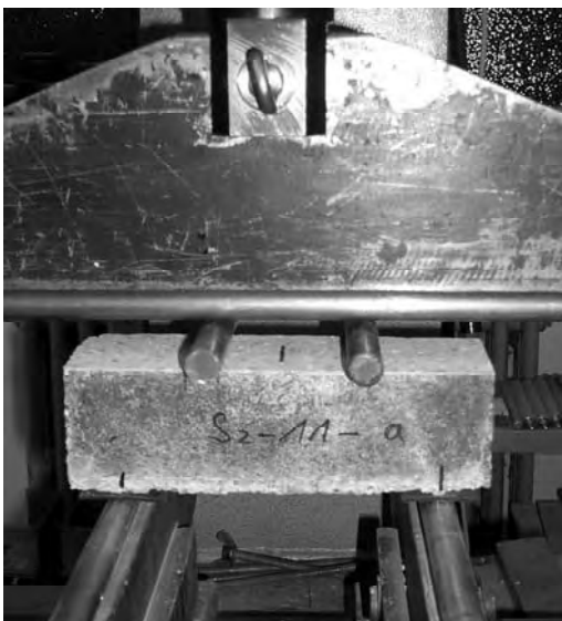
Bild 3-13: Darstellung des Biegezugversuches (a) sowie einer geprüften Probe (b)
