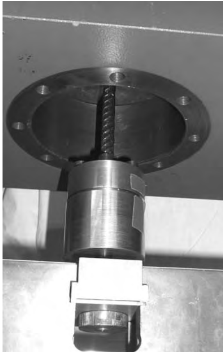
Bild 4-7: Einspannung des Bewehrungsstahls
