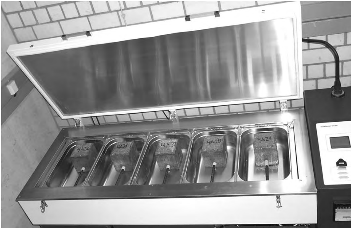
Bild 4-3: Befrostung der Ausziehkörper in der CIF-Frosttruhe
