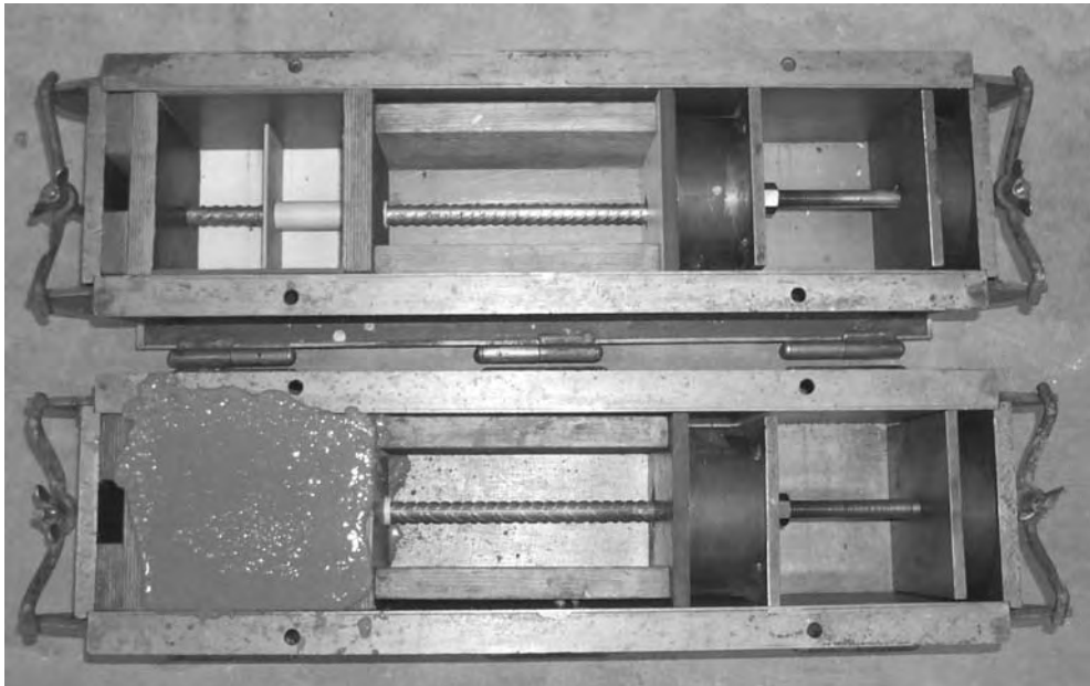
Bild 4-2: Schalungen der Ausziehkörper
