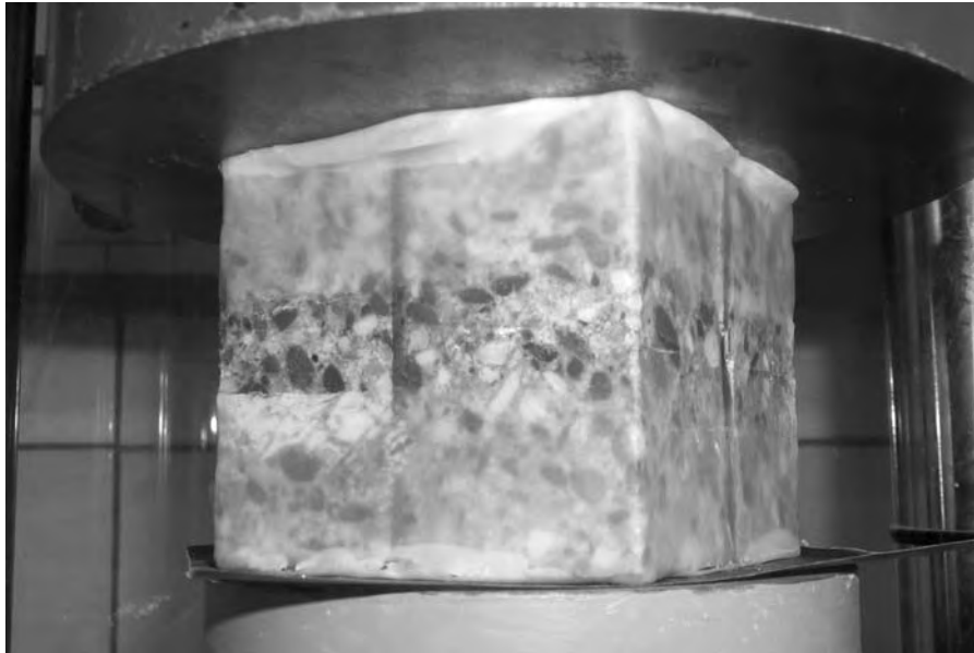
Bild 3-10: Darstellung der Druckprüfung mit Parafin beschichteten Prüfflächen
