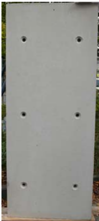
Bild 1: Probekörper der Prüfschalung „Wand“
